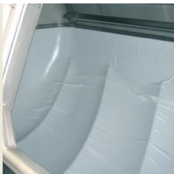
vynášecí element pro vysypání matolin pod membránou
